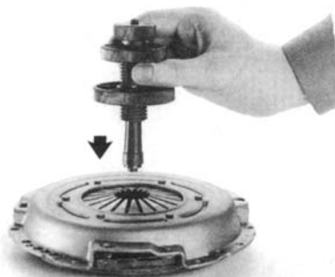
Univerzální přípravek k vystředění lamely spojky se zastrčí do otvoru (náboje lamely)
