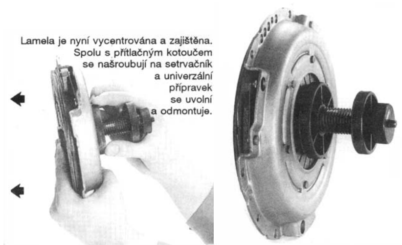
Obrázek 36 Vystředění kotouče u spojky bez vodícího ložiska
