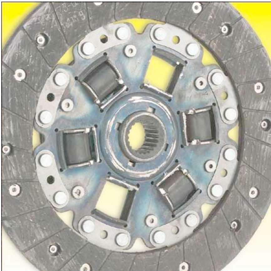
Obrázek 15 Kolize spojkového kotouče se setrvačником, nebo s vypínacím mechanismem
