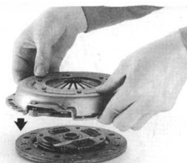
Přítlačný kotouč víka spojky se položí na kotouč spojky (lamela)
