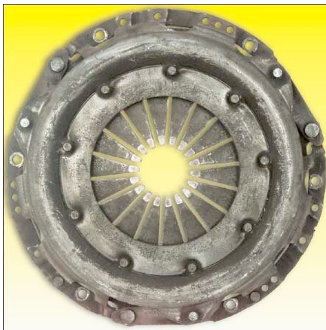
Obrázek 21 Nadměrně opotřebované (zeslabené) jazýčky membránové pružiny
