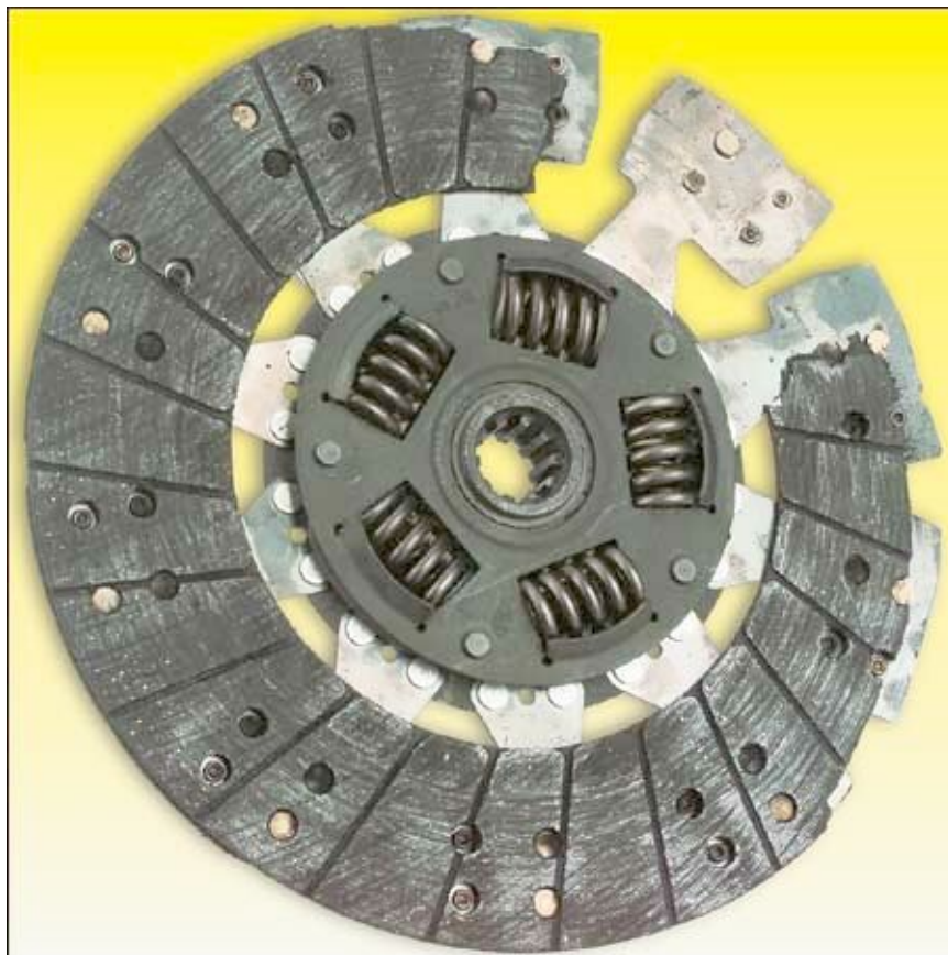
Obrázek 12 Zlomené a utržené obložení spojkového kotouče
