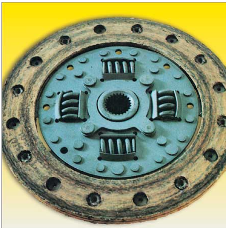
Obrázek 19 Obložení dosedá pouze na okrajích spojkového kotouče
