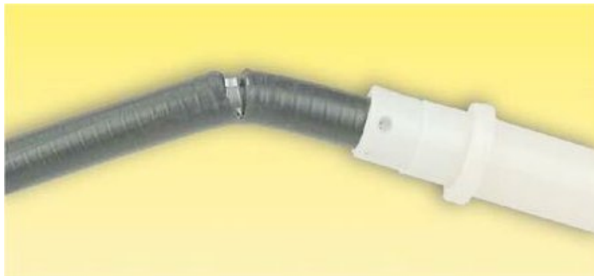
Obrázek 13 Porušený lanovod lanka spojky
