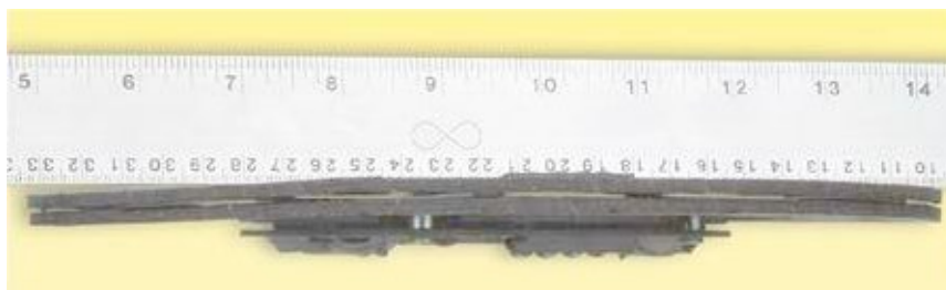
Obrázek 11 Deformovaný spojkový kotouč
