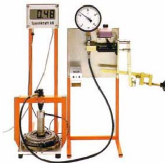
Obrázek 39 Učební a zkušební zařízení pro kontrolu činnosti spojky
