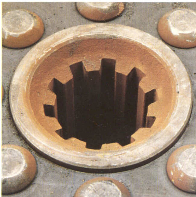
Obrázek 25 Zkorodovaný náboj spojkového kotouče
