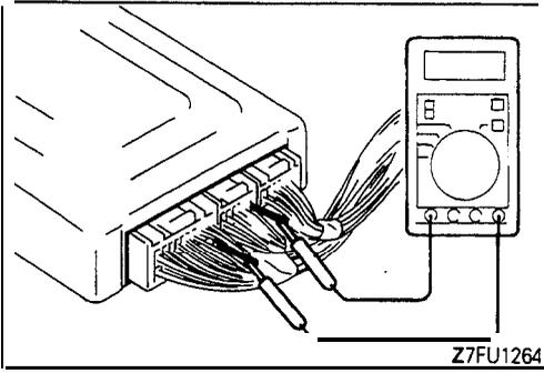
**ENGINE CONTROL MODULE (ECM) TERMINAL VOLTAGE INSPECTION**
