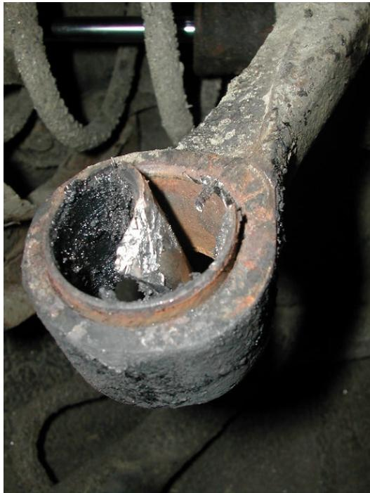
Když mámu gumi i kroužek venku, přistoupíme k demontáži pláště silentbloku z oka těhlice.
