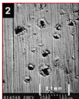
Špatná kvalita obrábění, extrémní množství otřepů po obrábění: nepoužitelné
